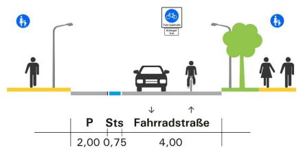
Abb. 52 Erforderliche Querschnittsbreiten bei Einrichtung einer Fahrradstraße und einseitigem Parken (Sts: Sicherheitstrennstreifen)
