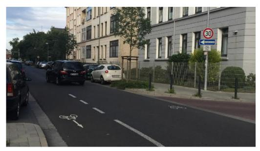
Abb. 21 Markierung von Fahrradpiktogrammen auf der Fahrbahn (Braunschweig)
